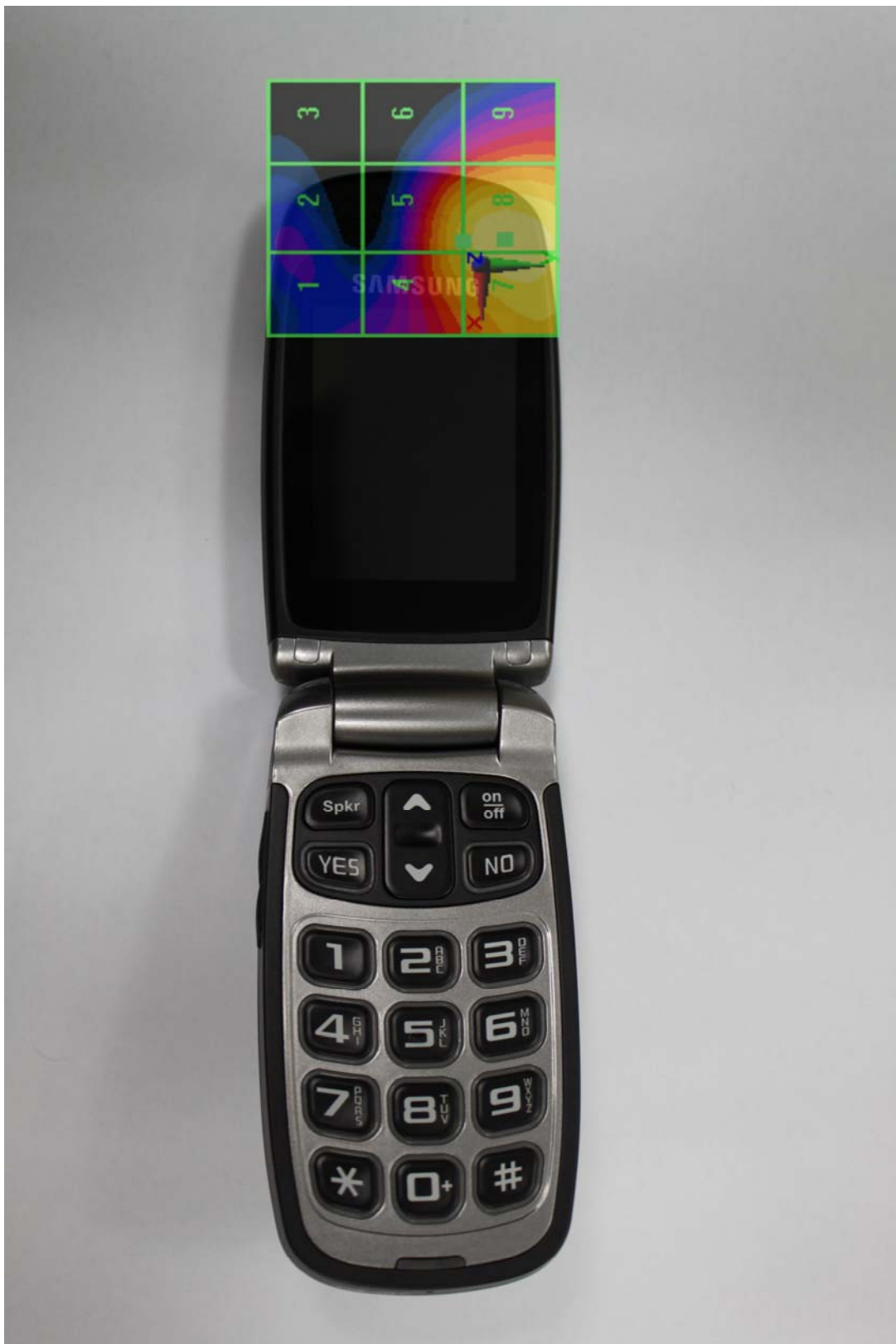
Scan Overlay with actual device(H-Field)
