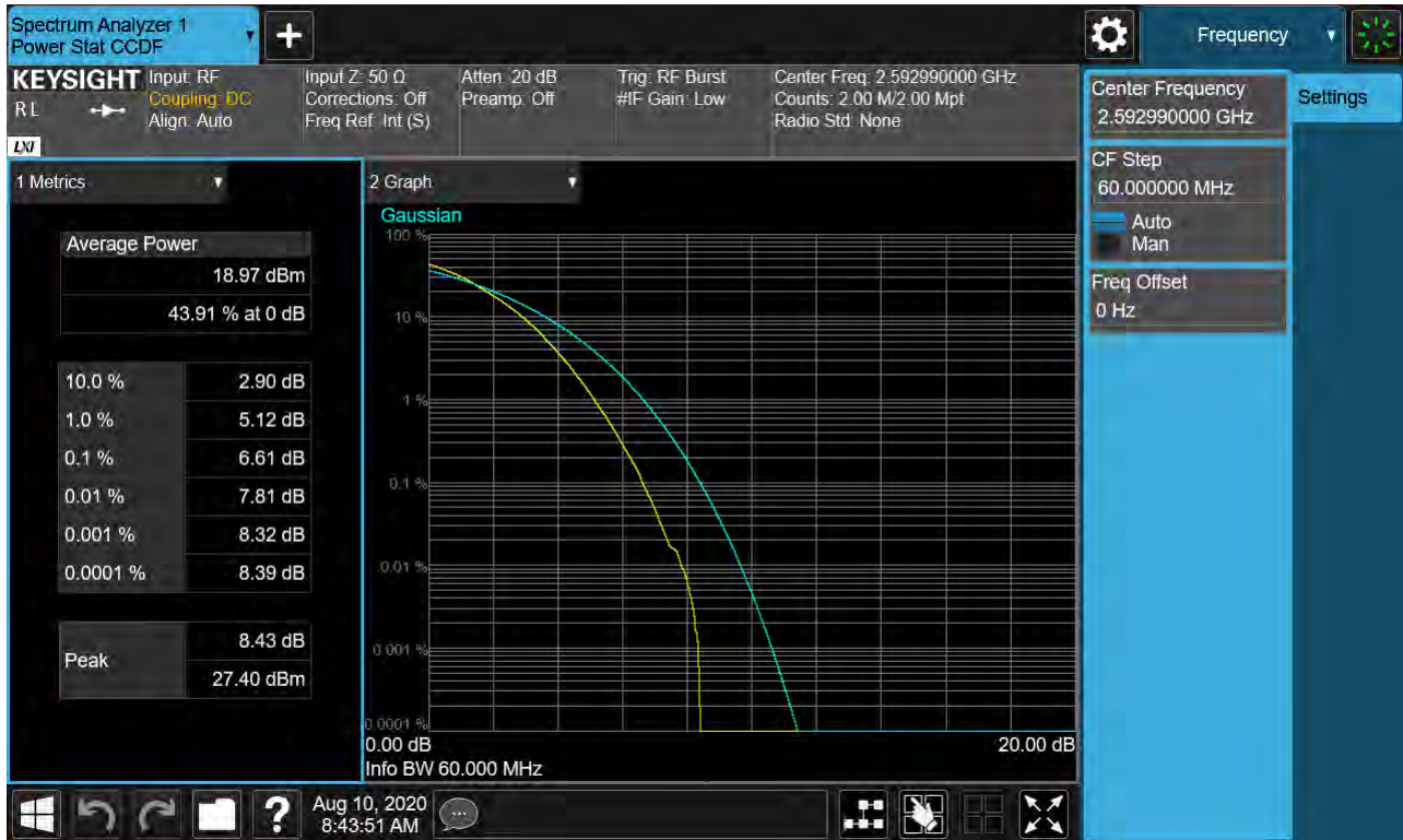
Sub6 n41. PAR Plot (60M BW_Ch.518598_256QAM_RB25_0)
