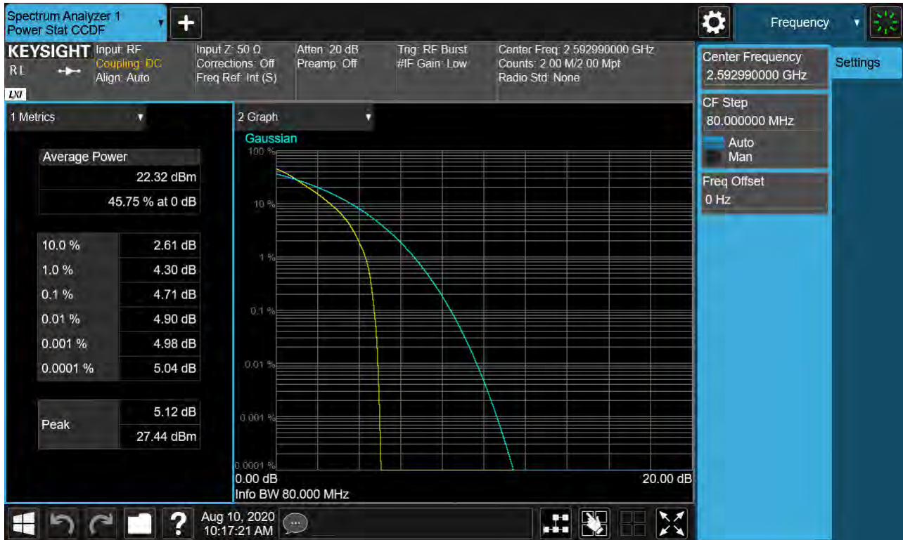
Sub6 n41. PAR Plot (80M BW_Ch.518598_QPSK_RB25_0)
