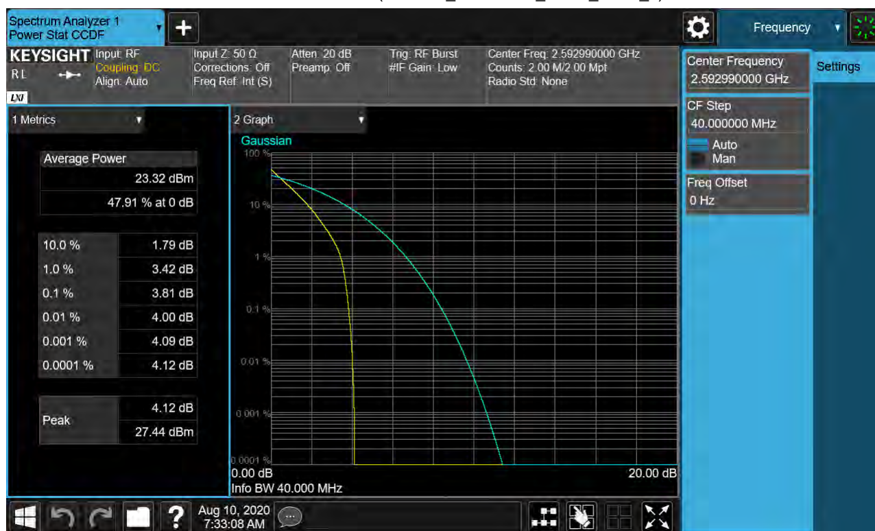
Sub6 n41. PAR Plot (40M BW_Ch.518598_BPSK_RB25_0)
