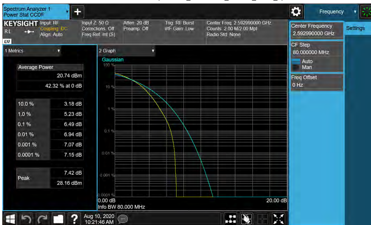
Sub6 n41. PAR Plot (80M BW_Ch.518598_64QAM_RB25_0)
