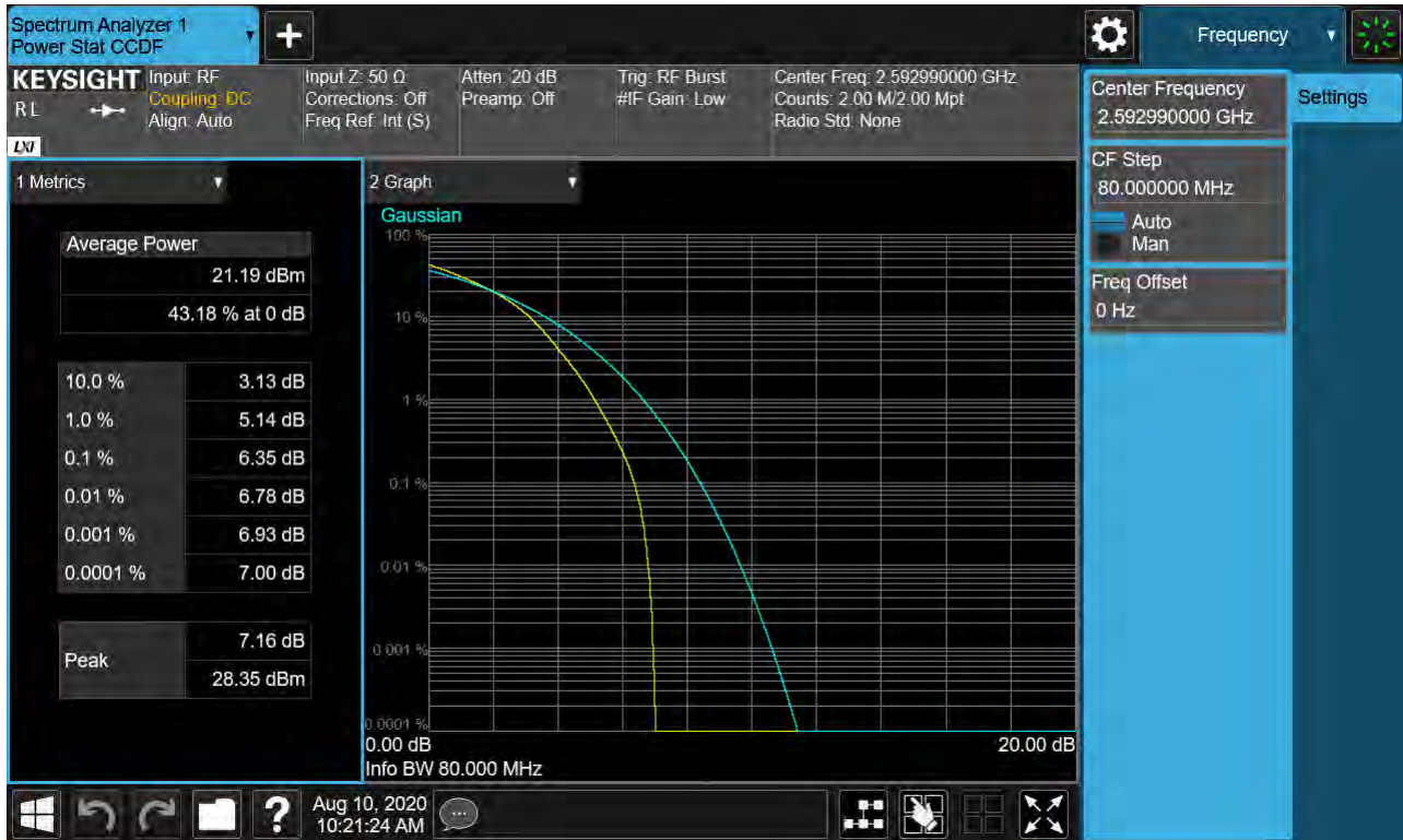
Sub6 n41. PAR Plot (80M BW_Ch.518598_16QAM_RB25_0)
