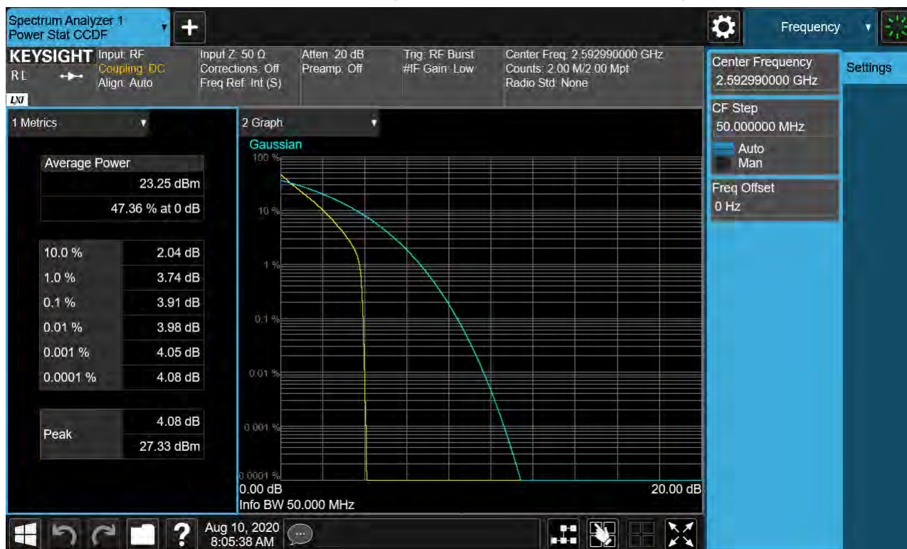
Sub6 n41. PAR Plot (50M BW_Ch.518598_BPSK_RB25_0)
