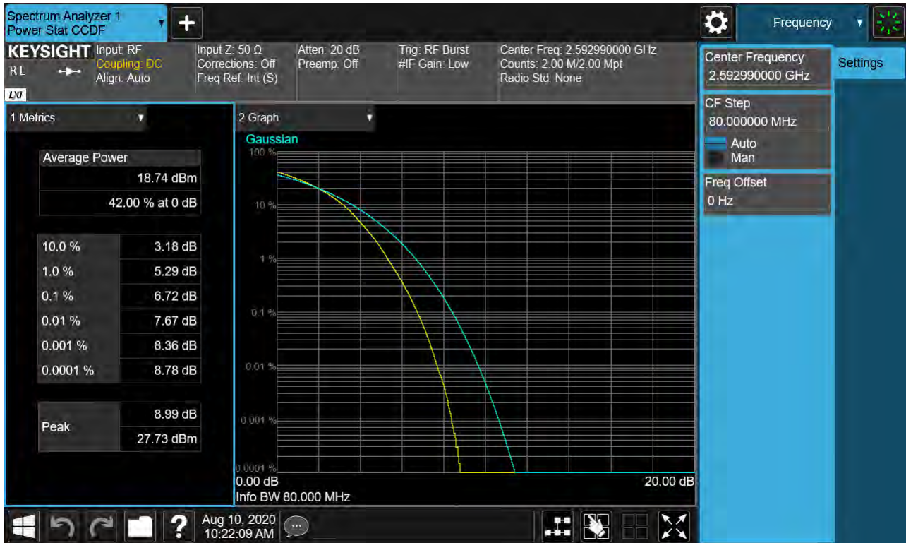
Sub6 n41. PAR Plot (80M BW_Ch.518598_256QAM_RB25_0)
