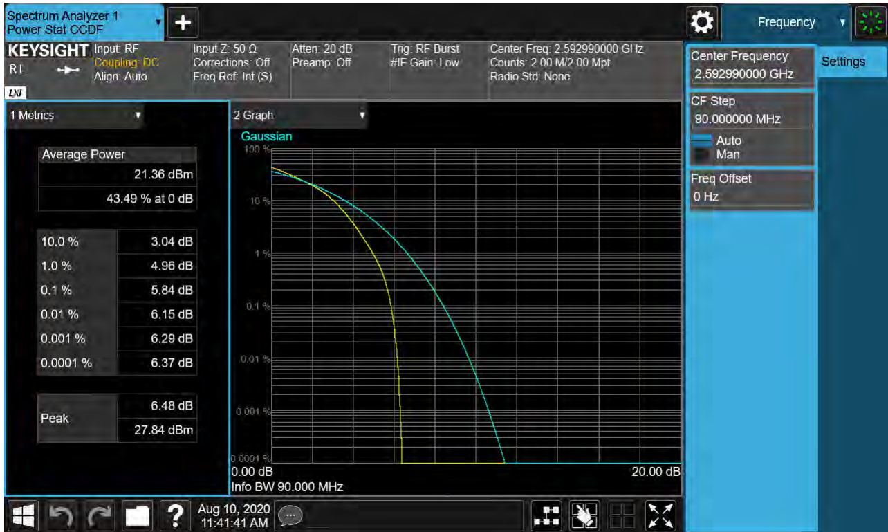
Sub6 n41. PAR Plot (90M BW_Ch.518598_16QAM_RB25_0)
