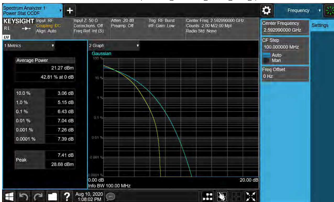
Sub6 n41. PAR Plot (100M BW_Ch.518598_64QAM_RB25_0)
