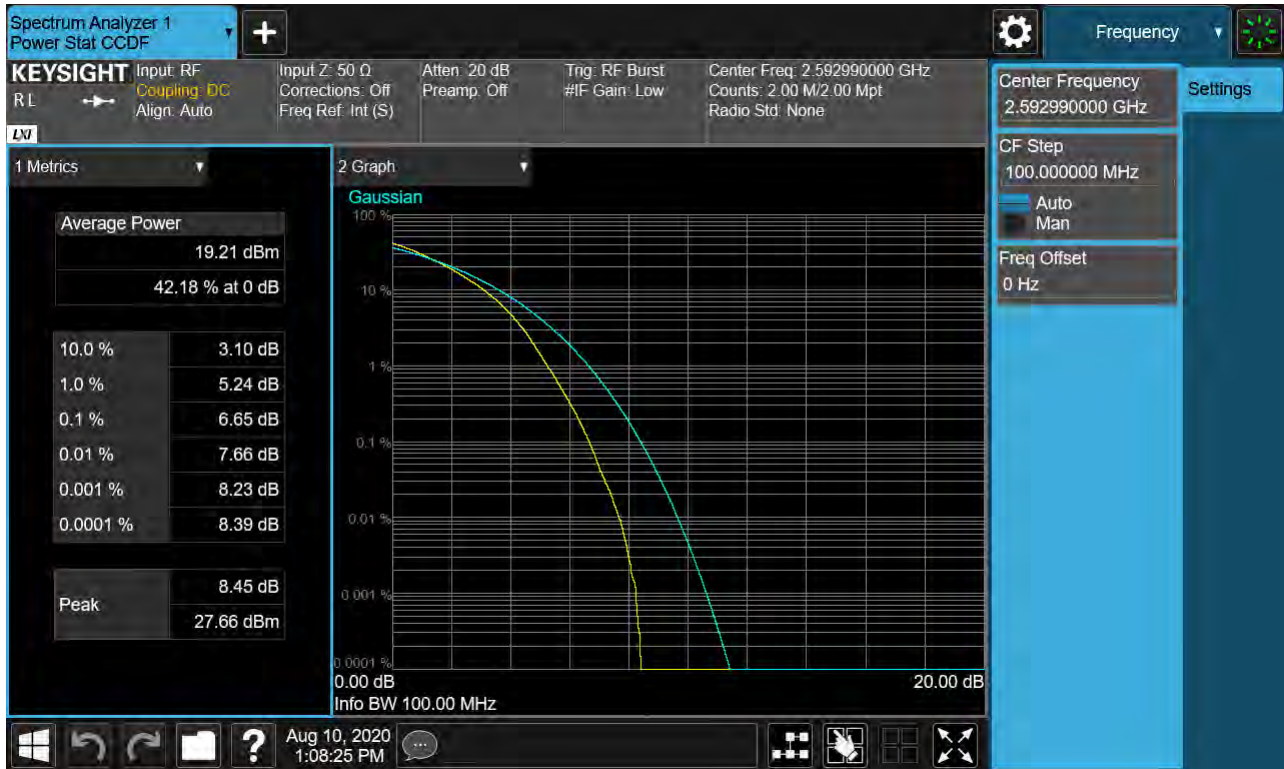
Sub6 n41. PAR Plot (100M BW_Ch.518598_256QAM_RB25_0)
