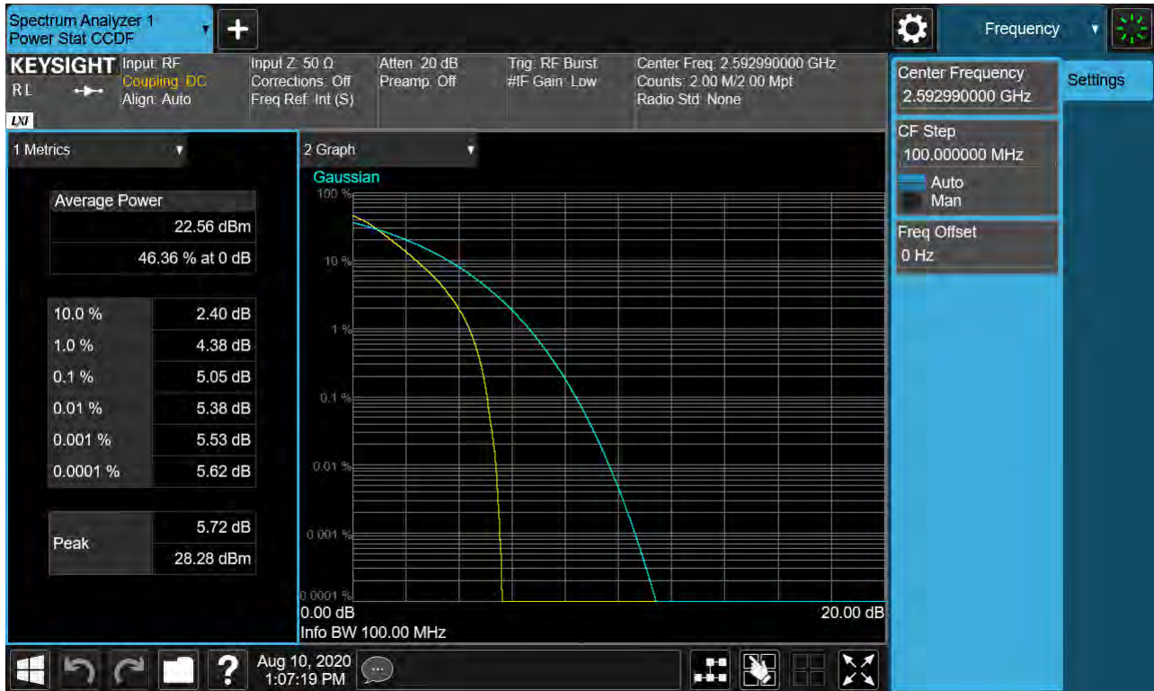
Sub6 n41. PAR Plot (100M BW_Ch.518598_QPSK_RB25_0)
