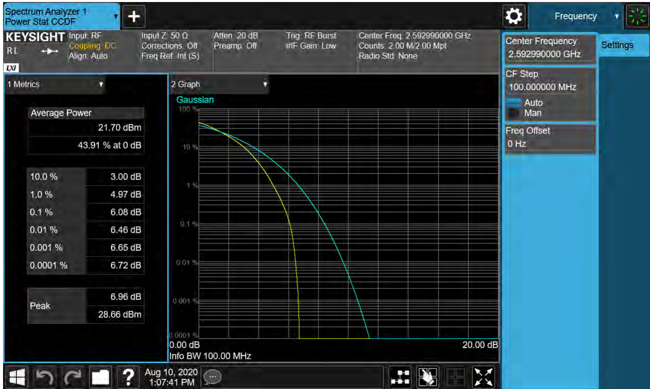
Sub6 n41. PAR Plot (100M BW_Ch.518598_16QAM_RB25_0)
