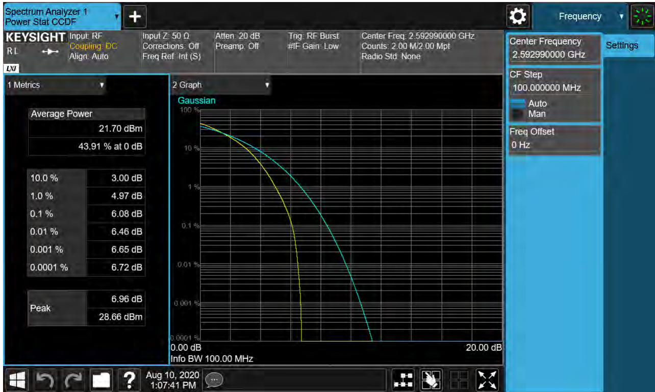
Sub6 n41. PAR Plot (100M BW_Ch.518598_16QAM_RB25_0)
