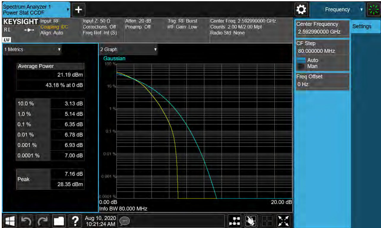
Sub6 n41. PAR Plot (80M BW_Ch.518598_16QAM_RB25_0)
