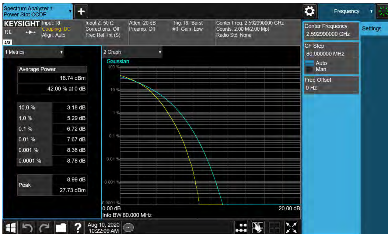
Sub6 n41. PAR Plot (80M BW_Ch.518598_256QAM_RB25_0)
