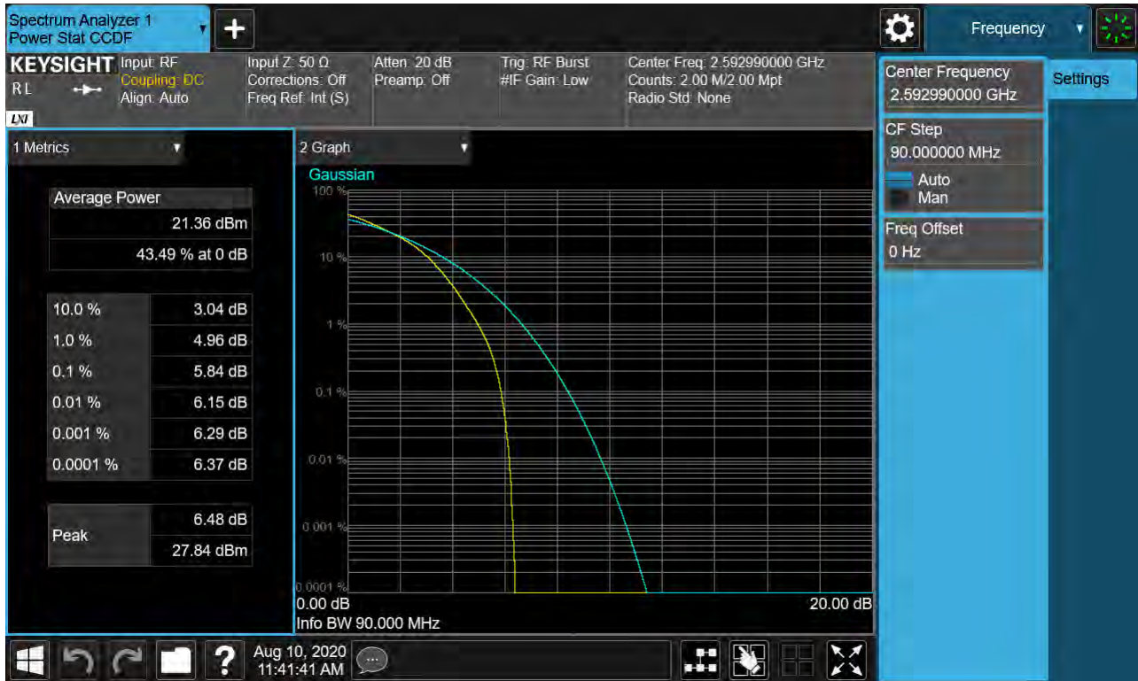
Sub6 n41. PAR Plot (90M BW_Ch.518598_16QAM_RB25_0)
