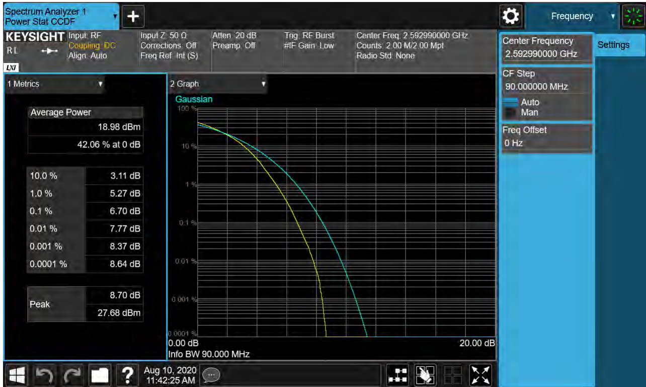
Sub6 n41. PAR Plot (90M BW_Ch.518598_256QAM_RB25_0)
