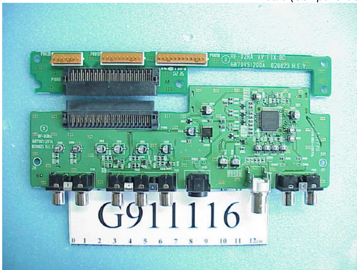
Figure 13 AV FIX Board (Component Side)
