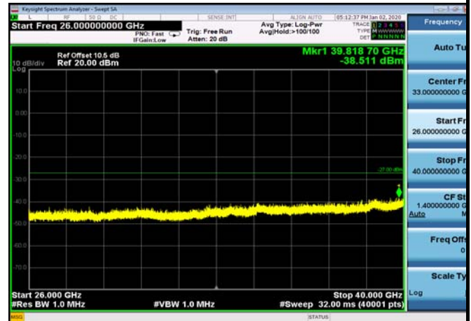
U-NII-1 ,Plot 2,26000MHz~40000MHz-802.11n (20MHz),5220MHz,Ant1
