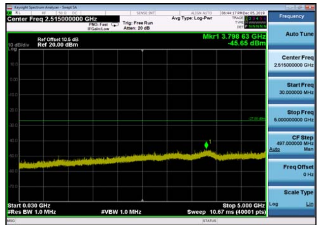
U-NII-1 ,Plot 3,5825MHz~7000MHz-802.1 1n(40MHz),5230MHz,Ant1
