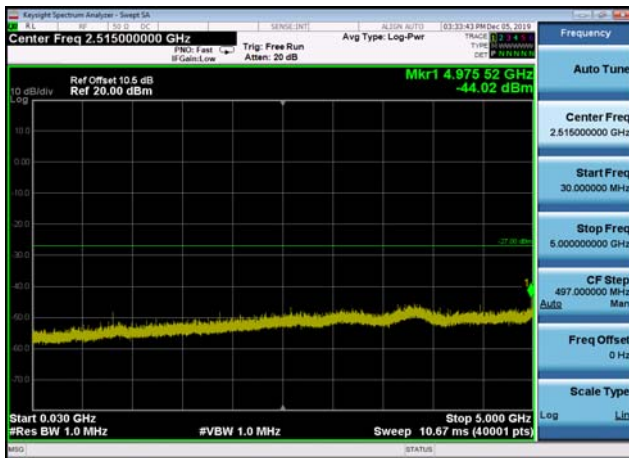
U-NII-1 ,Plot 2,30MHz~5000MHz-802.11a c(20MHz),5180MHz,Ant1
