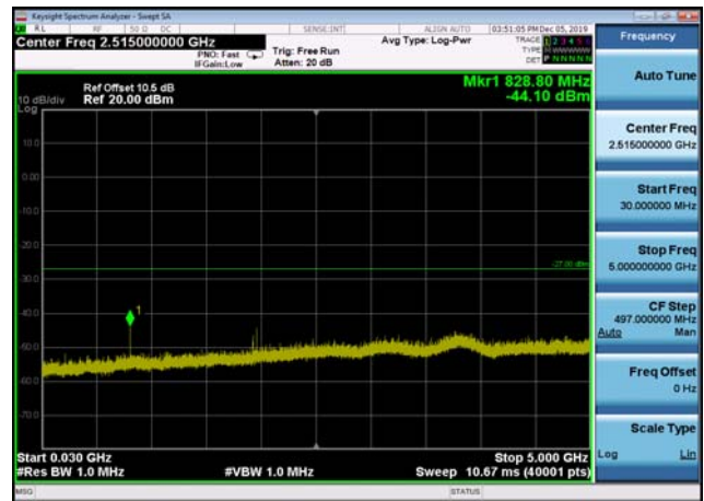
U-NII-1 ,Plot 2,30MHz~5000MHz-802.11a c(20MHz),5220MHz,Ant1
