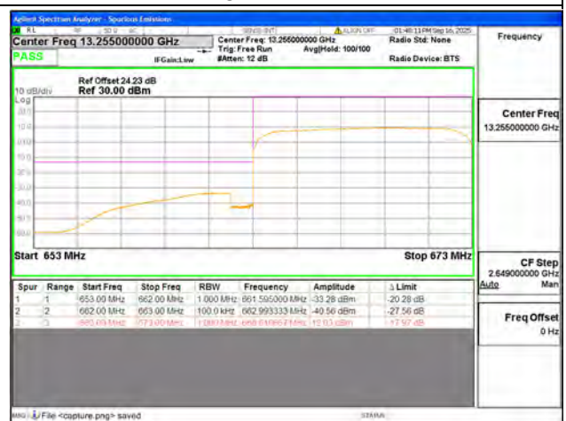
B71 / 10MHz / Low CH / QPSK / FULL RB
