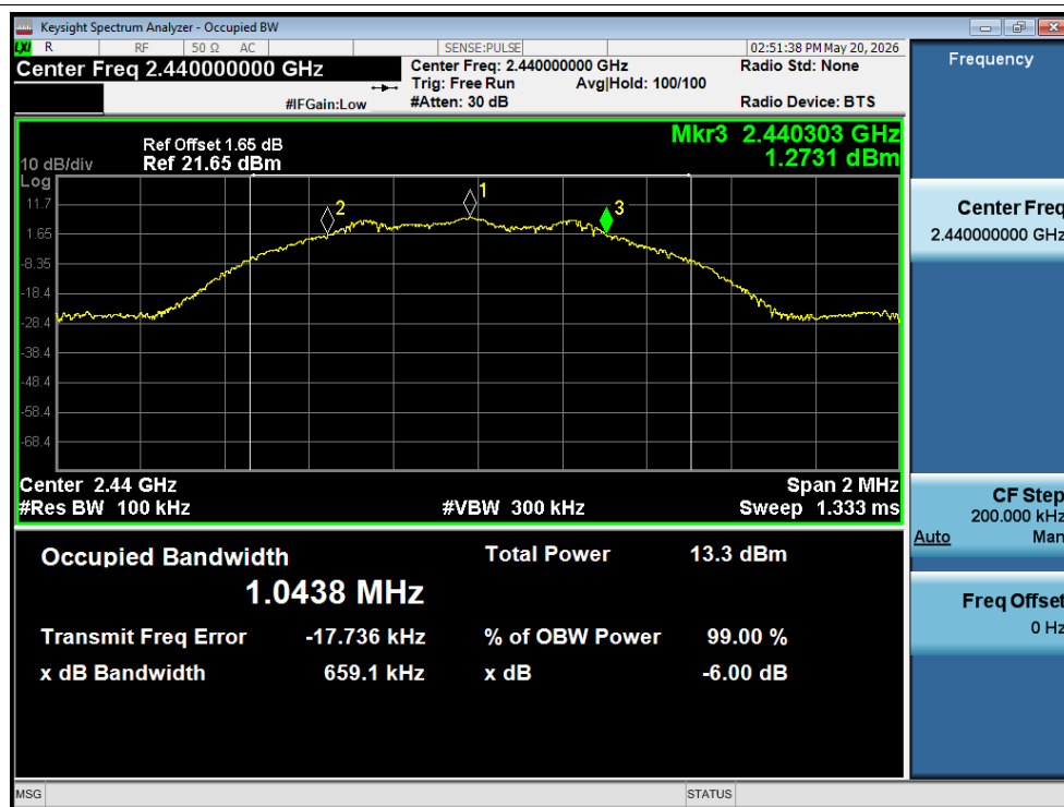
-6dB Bandwidth NVNT BLE 1M 2440MHz Ant1
