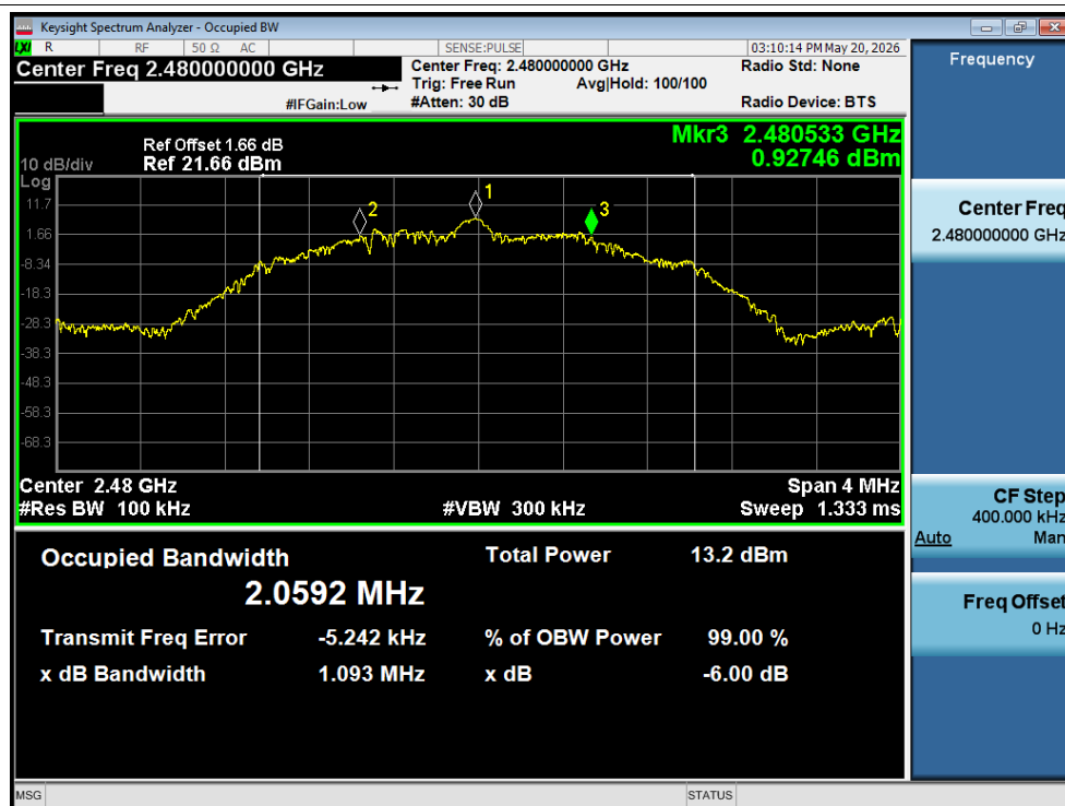
-6dB Bandwidth NVNT BLE 2M 2480MHz Ant1
