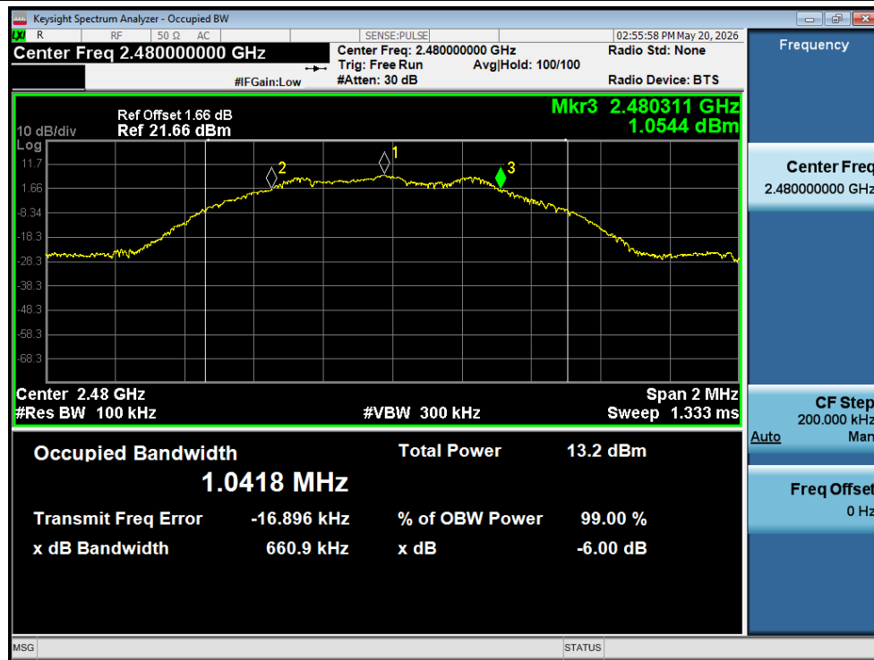
-6dB Bandwidth NVNT BLE 1M 2480MHz Ant1
