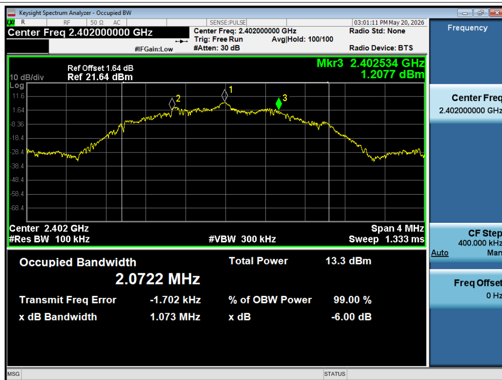
-6dB Bandwidth NVNT BLE 2M 2402MHz Ant1
