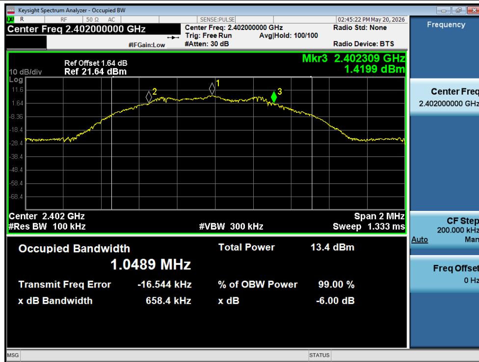
-6dB Bandwidth NVNT BLE 1M 2402MHz Ant1
