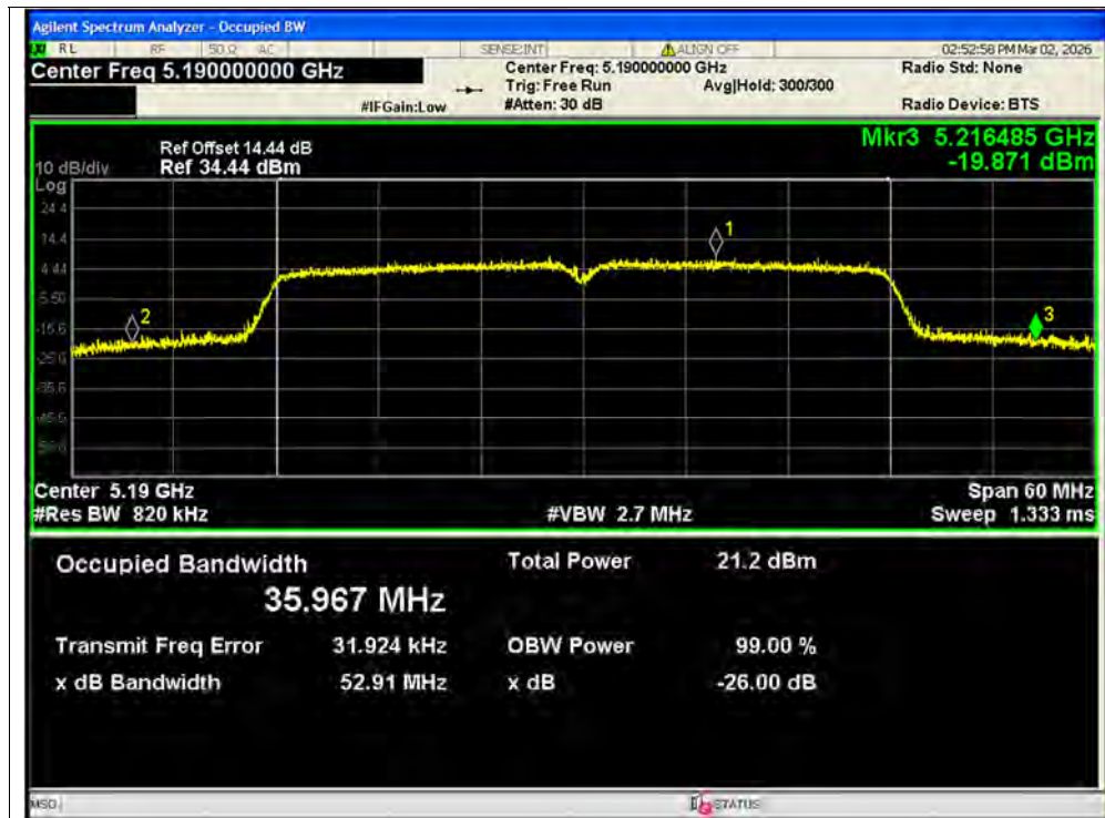
-26dB Bandwidth NVNT n40 5190MHz Ant1 MIMO
