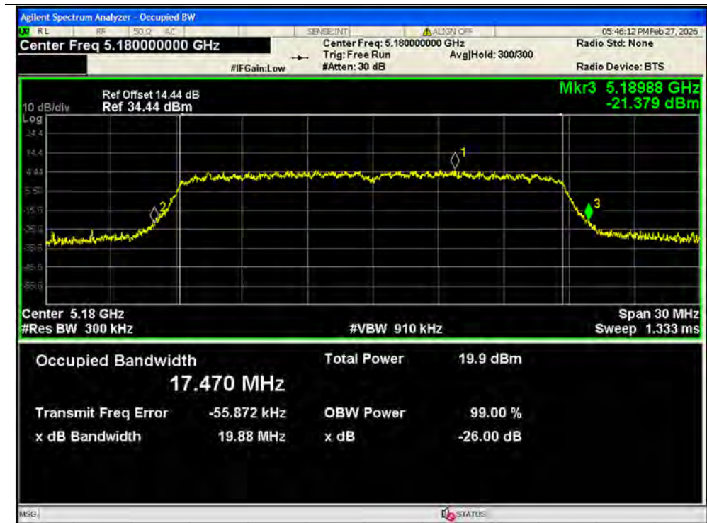
-26dB Bandwidth NVNT ac20 5180MHz Ant1 MIMO
