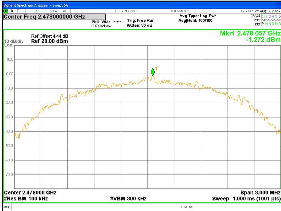
Tx. Spurious NVNT BLE 2M 2478MHz Ant1 Emission
