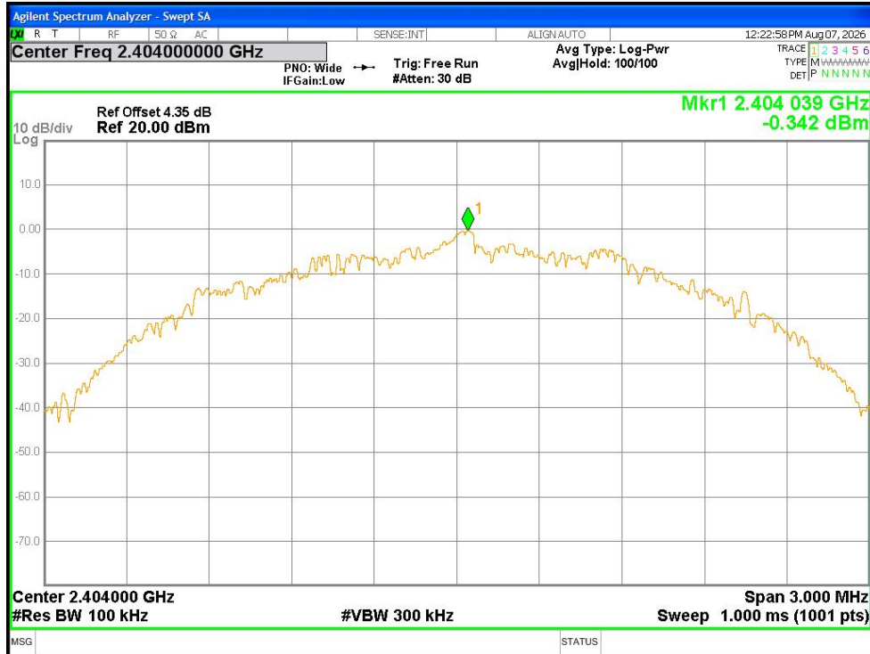
Tx. Spurious NVNT BLE 2M 2404MHz Ant1 Emission
