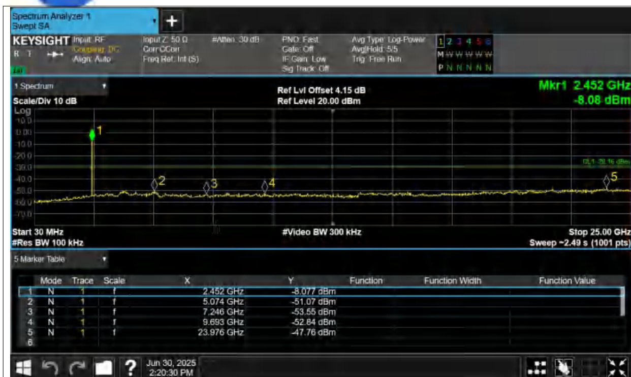
Tx. Spurious NVNT BLE 2480MHz Ant1 Ref
