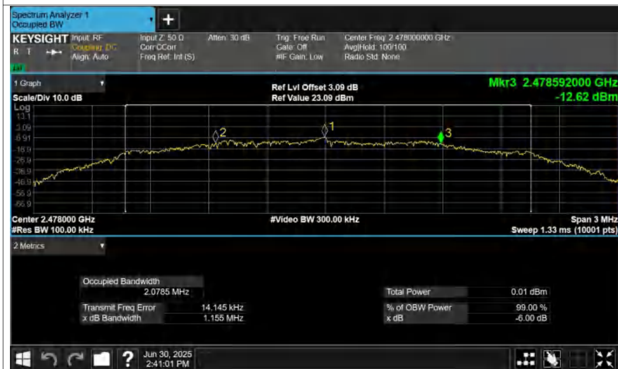
-6dB Bandwidth NVNT BLE 2478MHz Ant1
