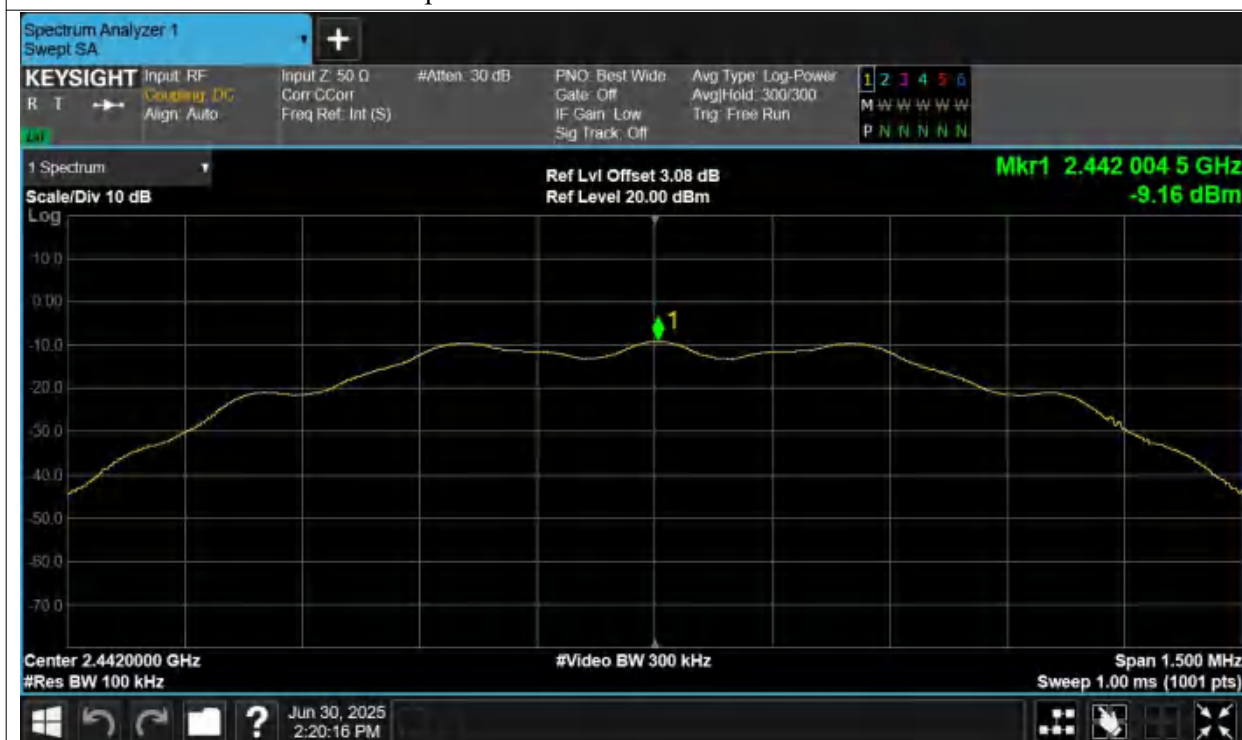
Tx. Spurious NVNT BLE 2442MHz Ant1 Emission
