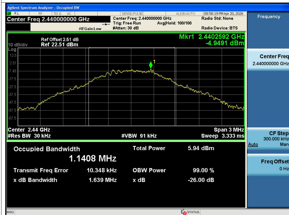
OBW NVNT BLE 1M 2440MHz Ant1
