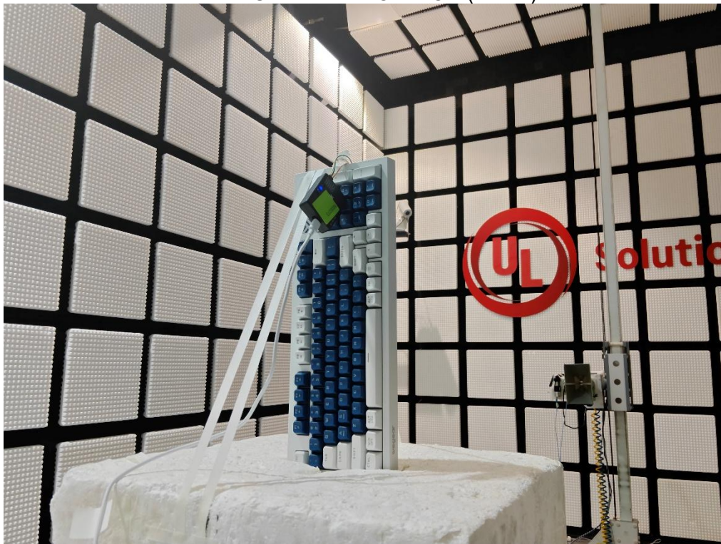
MEASUREMENT POSITION (Z axis)
