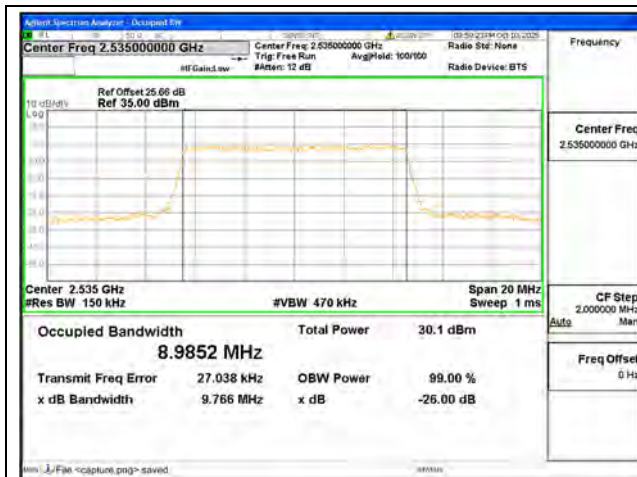
B7 / 10MHz / QPSK/ Mid CH
