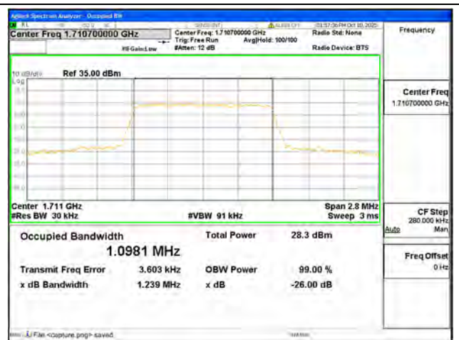
B4 / 1.4MHz / 16QAM / Low CH
