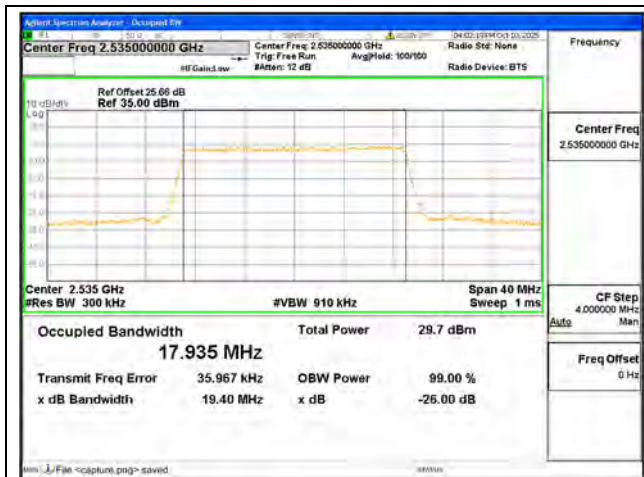
B7 / 20MHz / QPSK/ Mid CH
