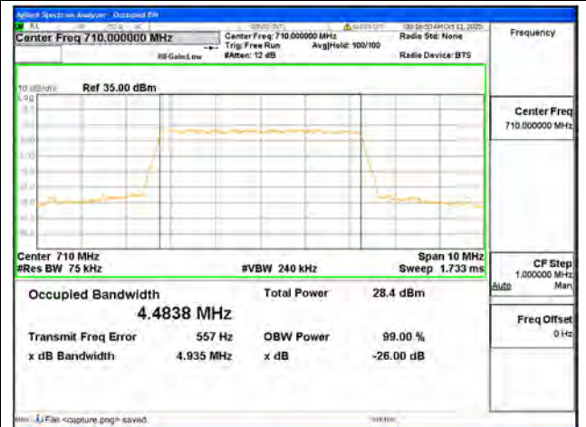
B17 / 5MHz / QPSK/ Mid CH
