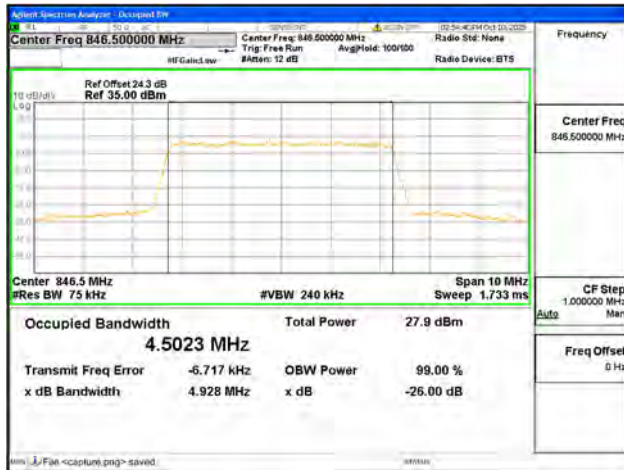
B5 / 5MHz / 64QAM/ High CH
