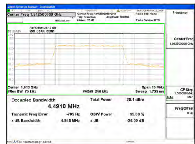
B25 / 5MHz / QPSK/ High CH
