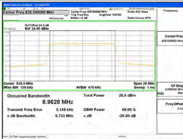
B5 / 10MHz / 64QAM/ Mid CH
