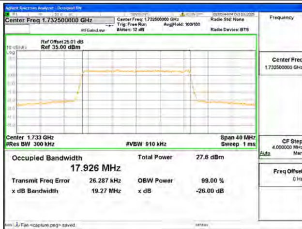
B4 / 20MHz / 64QAM/ Mid CH
