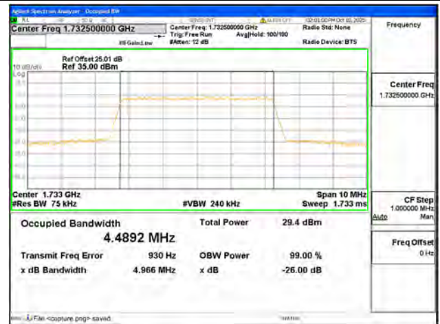
B4 / 5MHz / QPSK/ Mid CH
