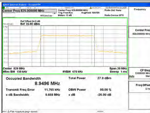
B5 / 10MHz / 16QAM/ Low CH
