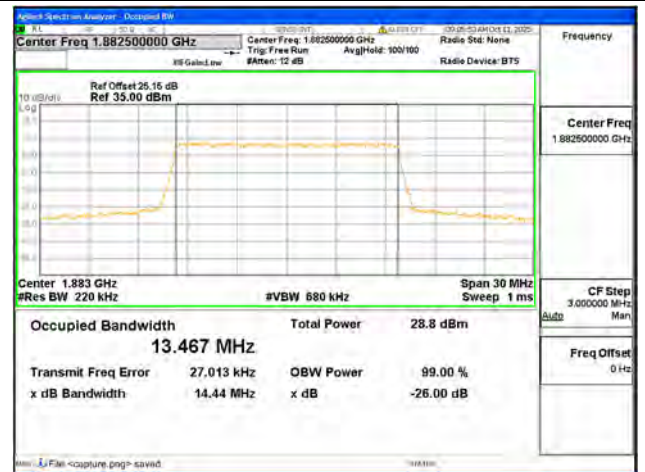
B25 / 15MHz / QPSK/ Mid CH
