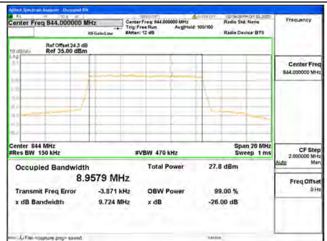
B5 / 10MHz / 64QAM/ High CH
