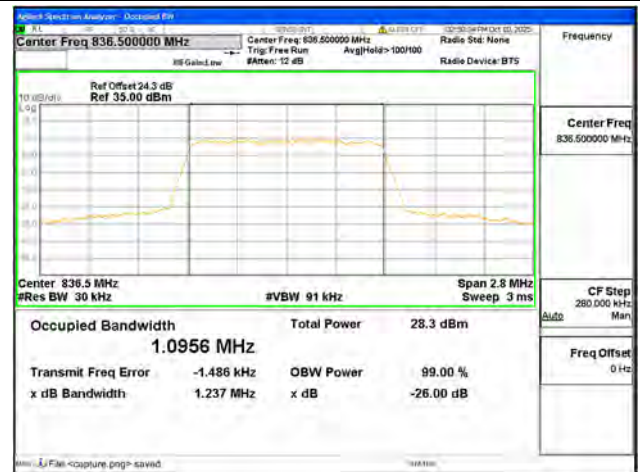
B5 / 1.4MHz / QPSK / Mid CH
