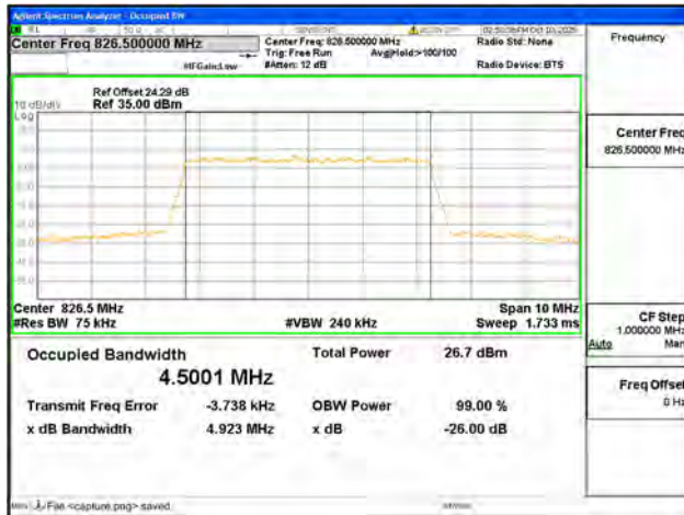
B5 / 5MHz / 64QAM/ Low CH
