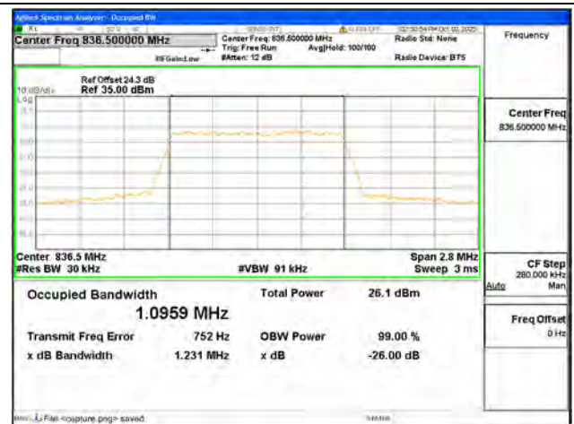
B5 / 1.4MHz / 64QAM / Mid CH
