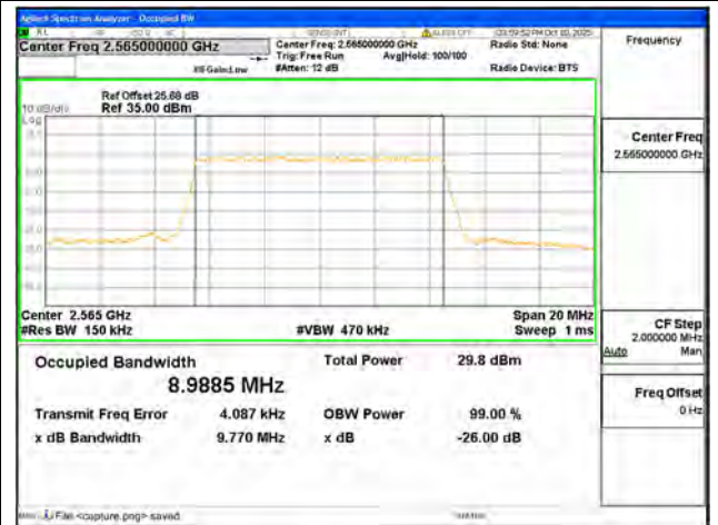
B7 / 10MHz / QPSK/ High CH
