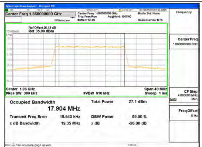
B2 / 20MHz / 64QAM/ Low CH
