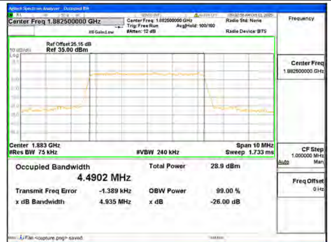
B25 / 5MHz / QPSK/ Mid CH
