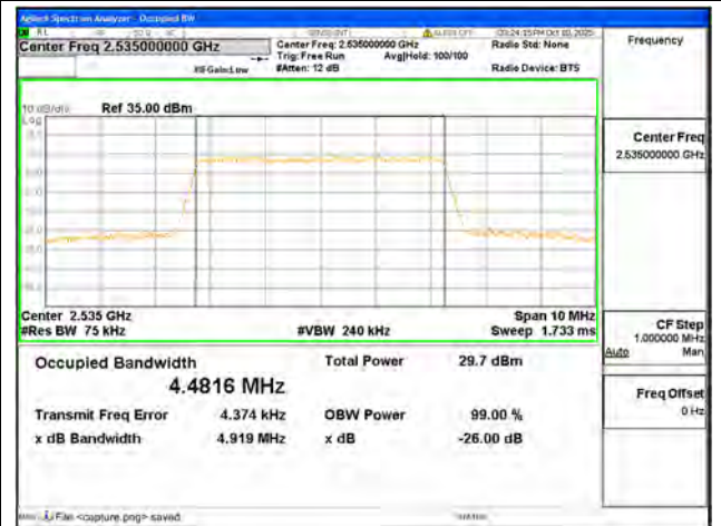
B7 / 5MHz / QPSK/ Mid CH
