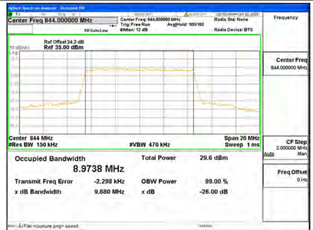
B5 / 10MHz / QPSK/ High CH
