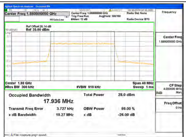
B2 / 20MHz / 16QAM/ Mid CH
