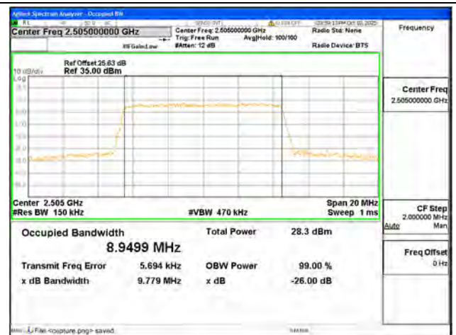
B7 / 10MHz / 64QAM/ Low CH
