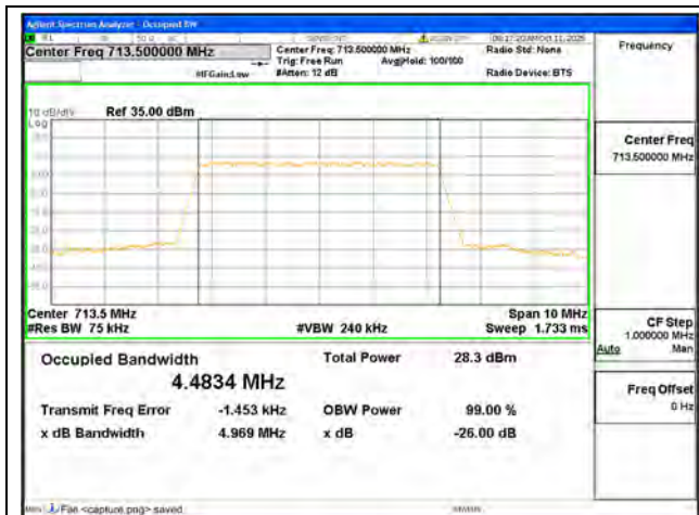
B17 / 5MHz / QPSK/ High CH
