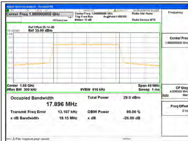
B2 / 20MHz / QPSK/ Mid CH
