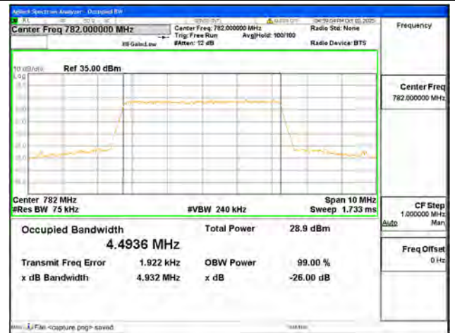
B13 / 5MHz / QPSK/ Mid CH
